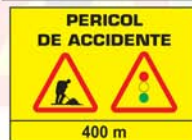
a44 Presemnalizarea unui sector cu circulația alternantă
