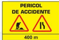
a43 Presemnalizarea unui sector cu circulația alternantă
